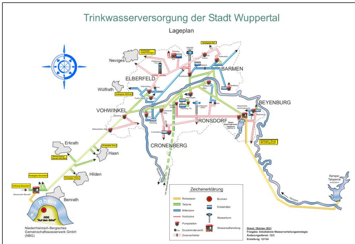
Abb. 6: Lageplan der Trinkwasserversorgung der Stadt Wuppertal (Quelle: WSW Energie & Wasser AG)
