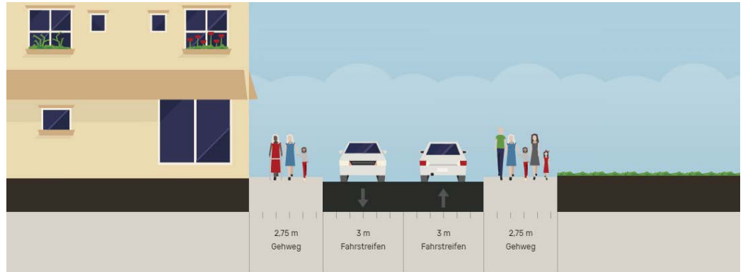
Abbildung 39: Planwerk 3, Variante 1 Fahrbahn 6,00m [Tool: Streetmix]
