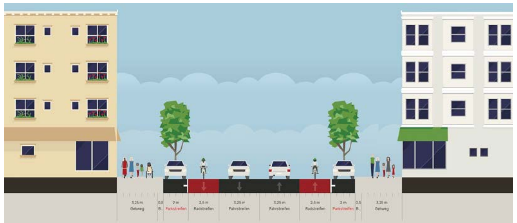
Abbildung 41: Planwerk 4, Variante 1 Radfahrstreifen [Tool: Streetmix]
