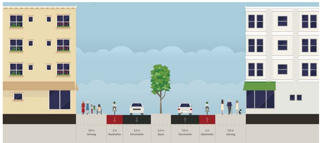
Abbildung 30: Planwerk 2, Variante 2 Radfahrstreifen [Tool: Streetmix]
