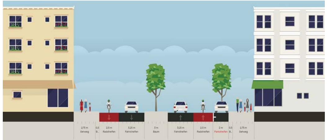
Abbildung 43: Planwerk 4, Variante 3 Radfahrstreifen mit Mittelstreifen [Tool: Streetmix]
