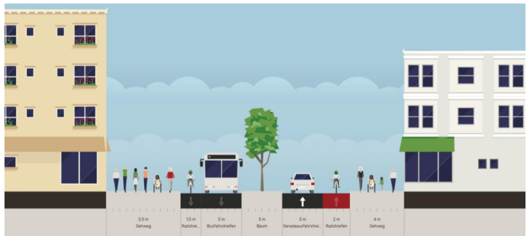
Abbildung 36: Planwerk 2, Variante 4.2 Ringvariante mit Umweltspur [Tool: Streetmix]
