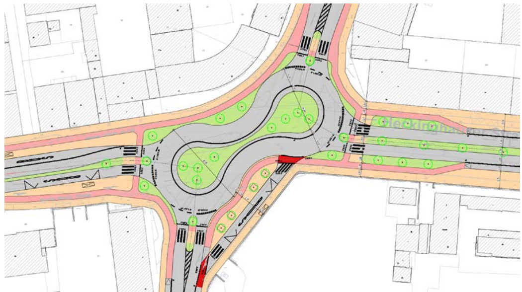
Abbildung 32: Planwerk 2, KP Brändströmstraße, Schlaufenkreisel
