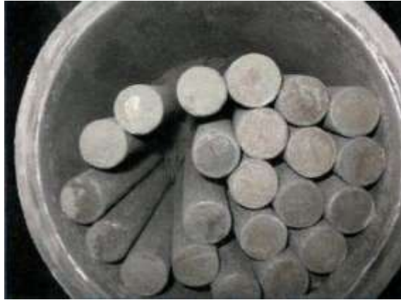
Mahlbehälter einer Schlagmühle mit Mahlstäben G
