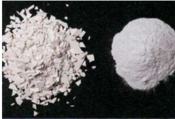
Partikel nach ungekühltem (links), gekühltem Mahlen (rechts) D
