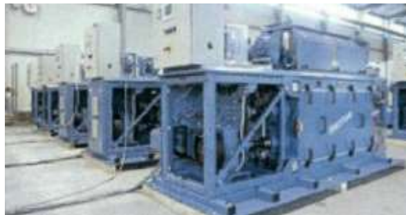
Walzenmühle im Industriemaßstab H
