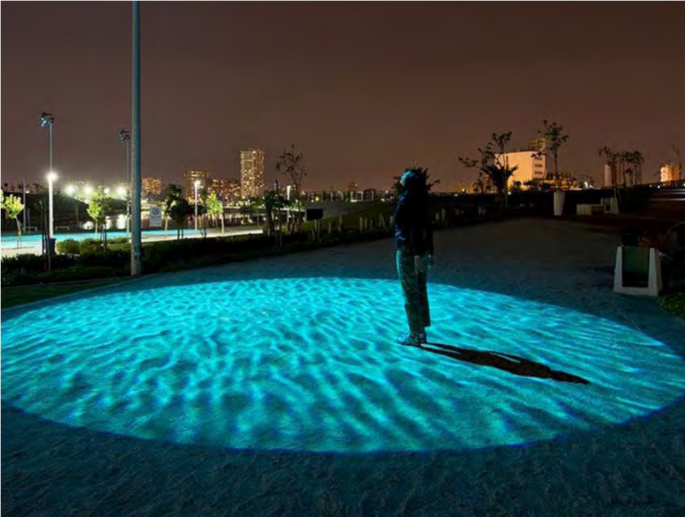
Assoziationsfoots unterschiedlicher GOBO-Projektionen. Mittels Überlagerung von unscharfen (Wellen-)motiven, die langsam rotieren, können dynamische Projektionen erzeugt werden wie Wasserbewegung oder Flammenwirkung.
