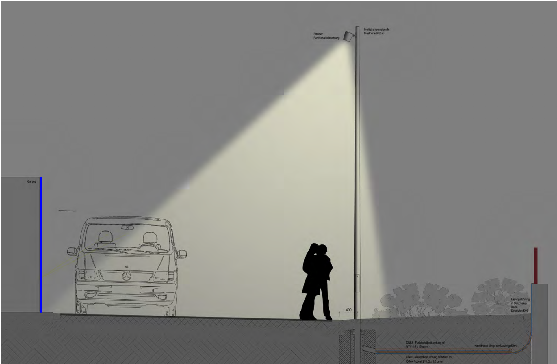
Street-Optik zur funktionalen Ausleuchtung der Verkehrsfläche sowie des Gehweges.
