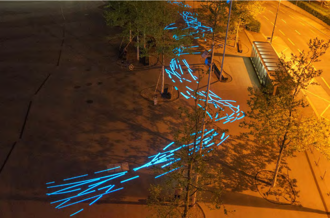
Assoziationsfoots unterschiedlicher Projektionen. Beispiel - Richtungsweisende Motive werden konturenscharf auf die Bodenfläche projiziert. So können Bewegungsströme visuell gelenkt bzw. simuliert werden.
