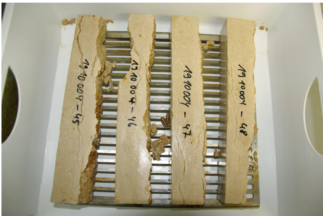
Foto 65: Prüfkörper -45 bis -48 nach dem 40. Zyklus
