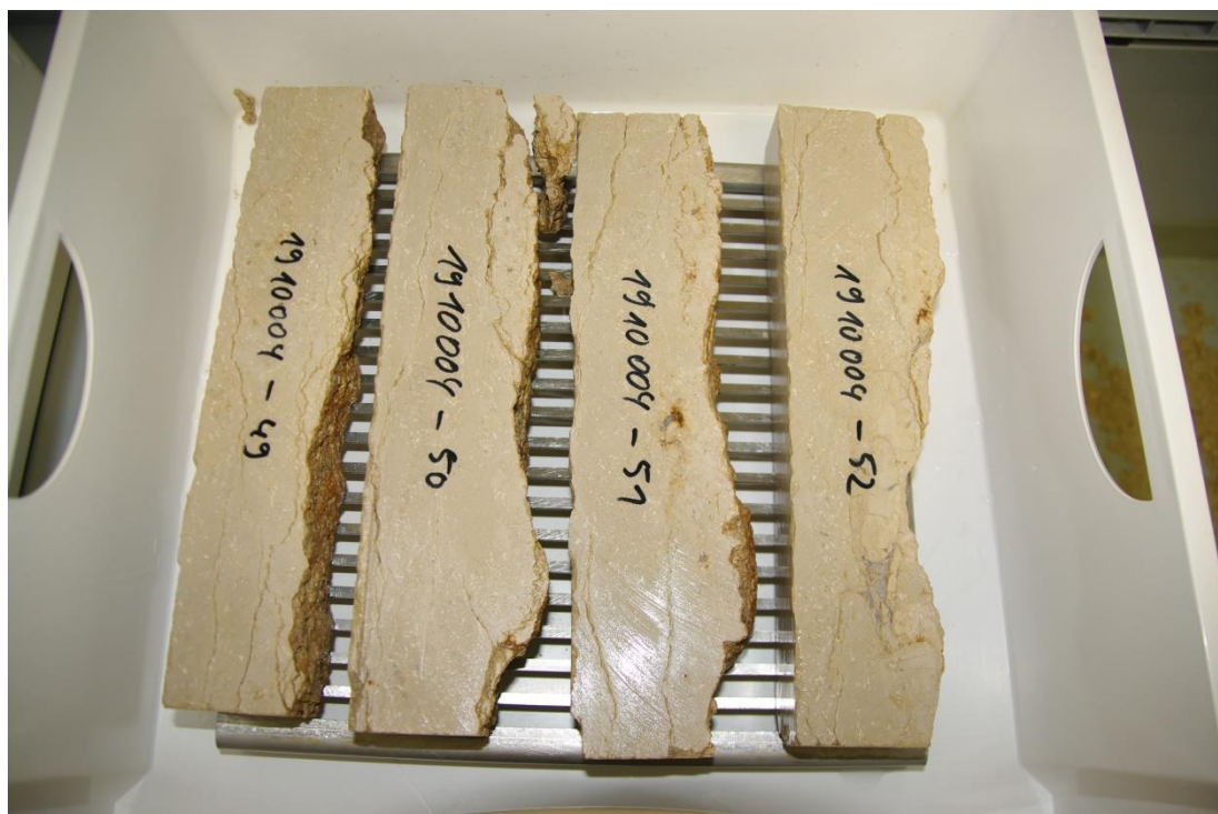
Foto 63: Prüfkörper -49 bis -52 nach dem 35. Zyklus
