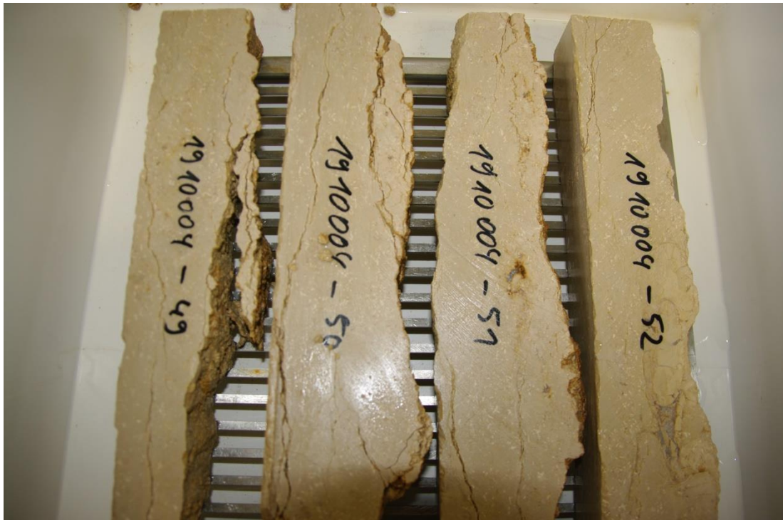
Foto 71: Prüfkörper -49 bis -52 nach dem 50. Zyklus
