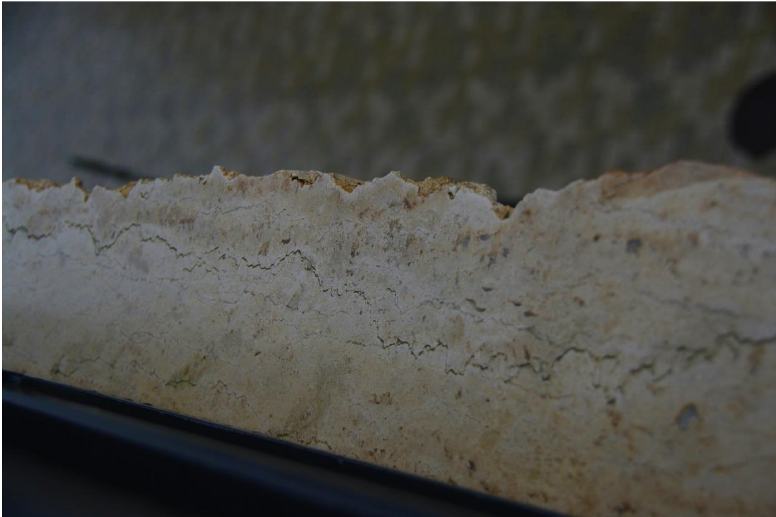
Foto 6: erkennbare Stylolithen auf der Steinoberfläche
