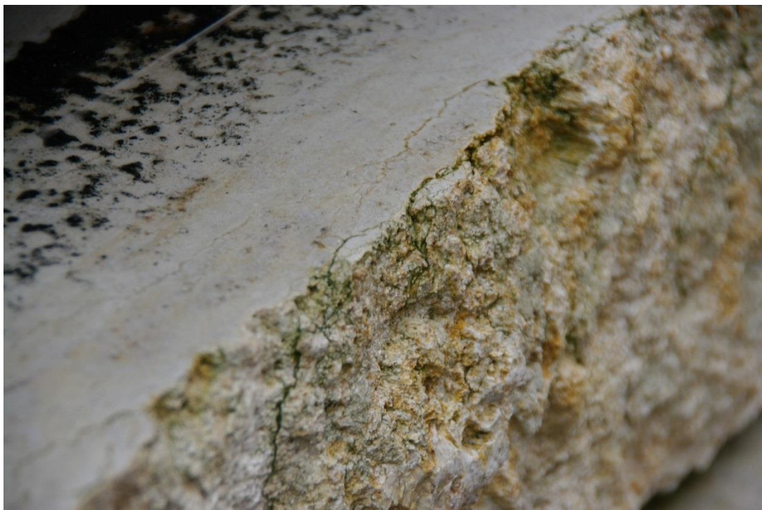
Foto 8: Ablösungserscheinungen resp. Ausbildung von Scherben an der Krustenoberfläche
