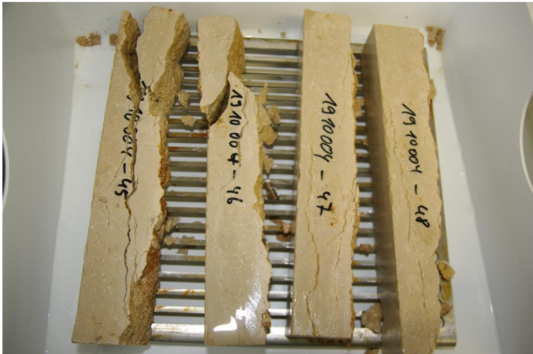
Foto 67: Prüfkörper -45 bis -48 nach dem 45. Zyklus; Prüfkörper -45 und -46 komplett zerstört
