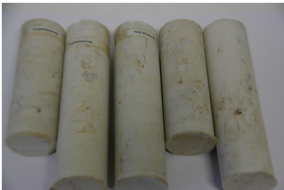
Foto 74: Bohrkerne aus der Vorhangfassade
