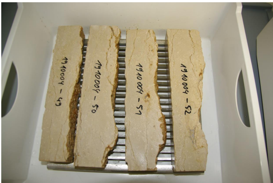
Foto 61: Prüfkörper -49 bis -52 nach dem 30. Zyklus
