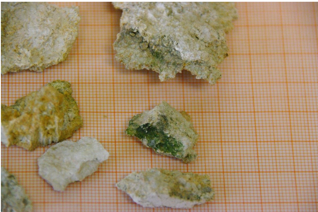
Foto 14: Beispiele für abgenommene Scherben; hier Detailaufnahme aus Foto 13: beginnende Algen- und Moosbildungen an der grünlichen Farbe erkennbar
