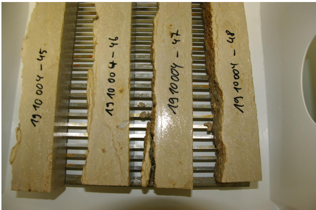
Foto 55: Prüfkörper -47 nach dem 5. Zyklus
