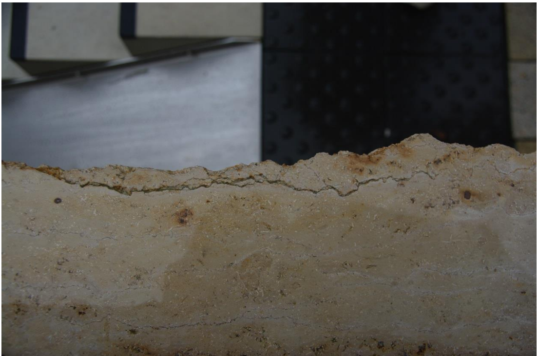
Foto 19: an der Krustenoberfläche „auskeilende“ Stylolithen
