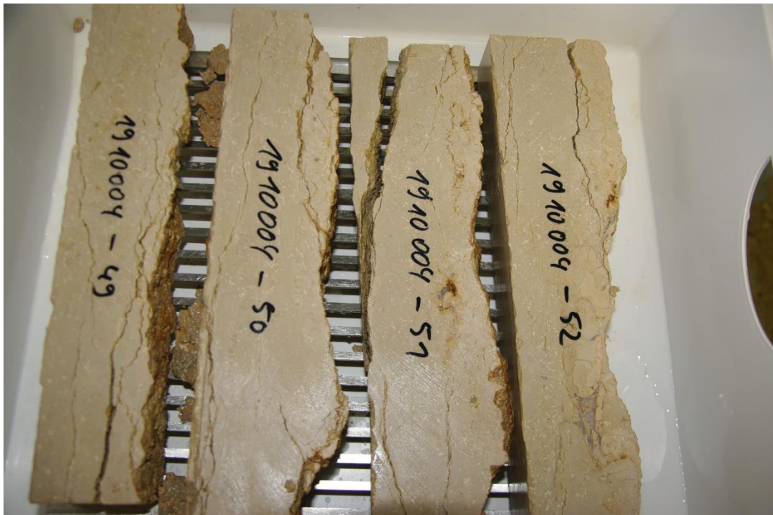
Foto 68: Prüfkörper -49 bis -52 nach dem 45. Zyklus
