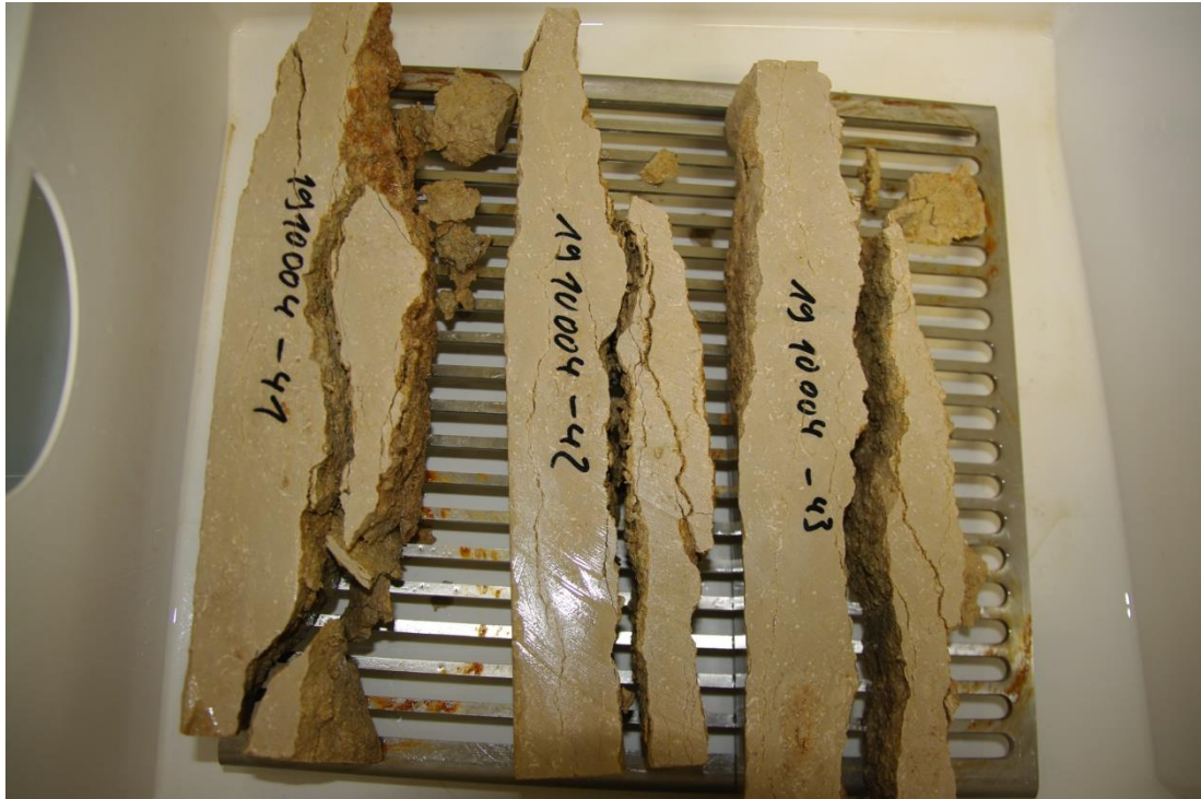
Foto 72: Prüfkörper -41 bis -43 nach Ende des Versuchs; alle Prüfkörper komplett zerstört
