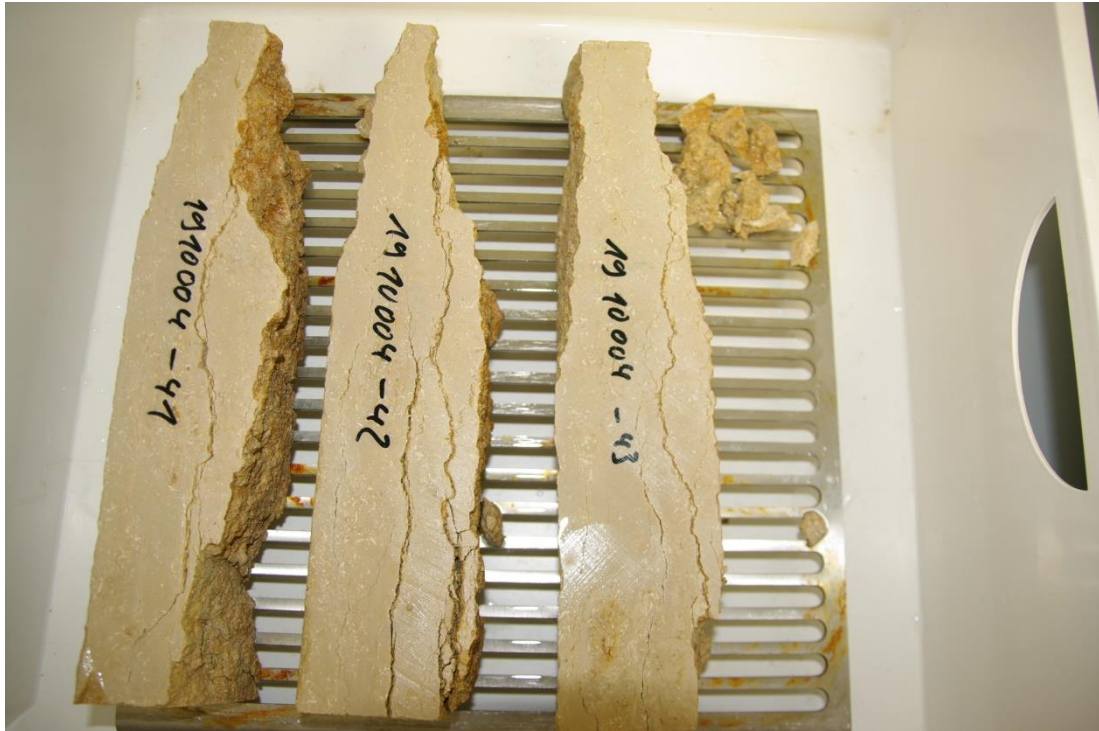
Foto 66: Prüfkörper -41 bis -43 nach dem 45. Zyklus
