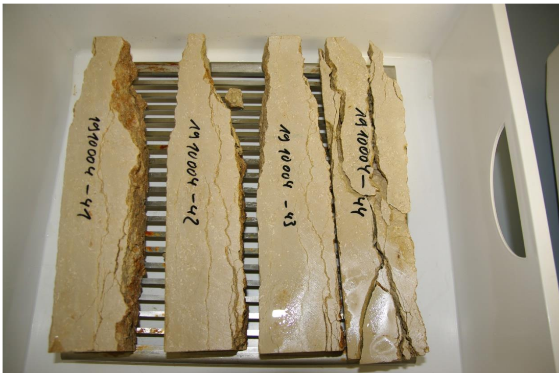
Foto 64: Prüfkörper -44 nah dem 38. Zyklus komplett zerstört
