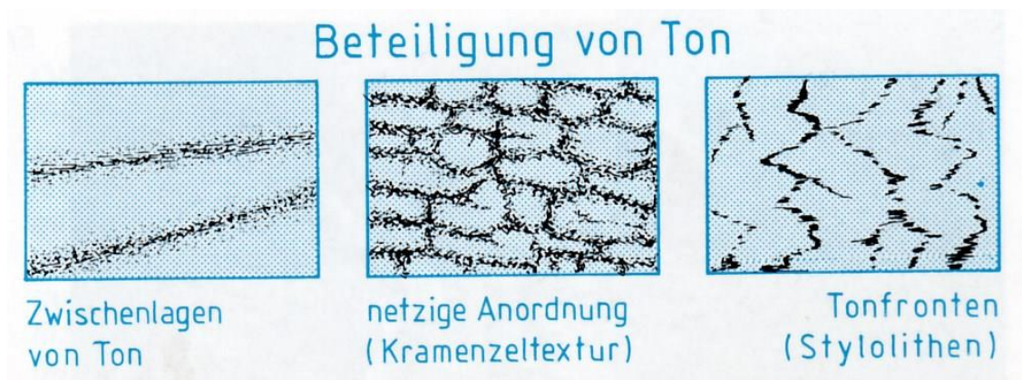
Abb. 1: Möglichkeiten der Einlagerung von Tonen in Kalksteinen
