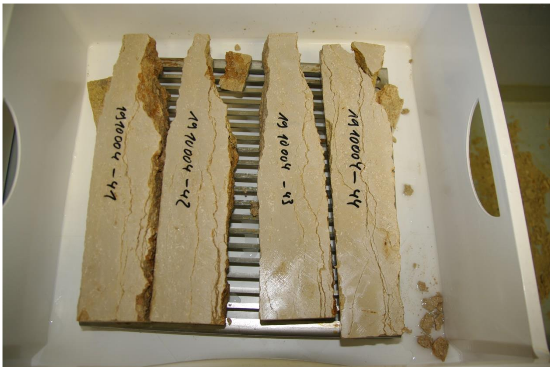
Foto 59: Prüfkörper -41 bis -44 nach dem 30. Zyklus
