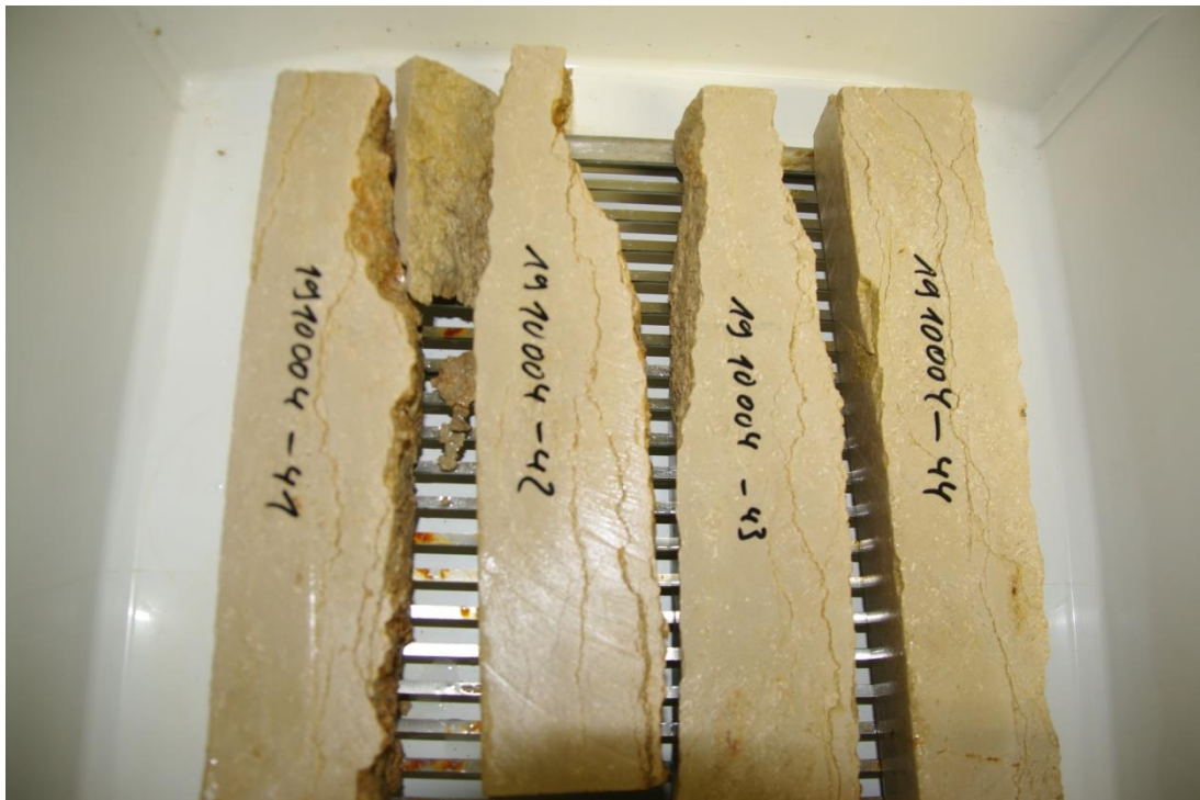
Foto 56: Prüfkörper -42 nach dem 20. Zyklus
