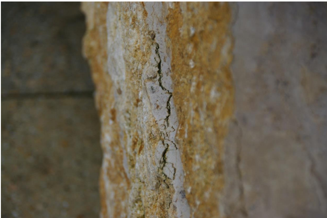
Foto 21: an der Krustenoberfläche „auskeilende“ Stylolithen
