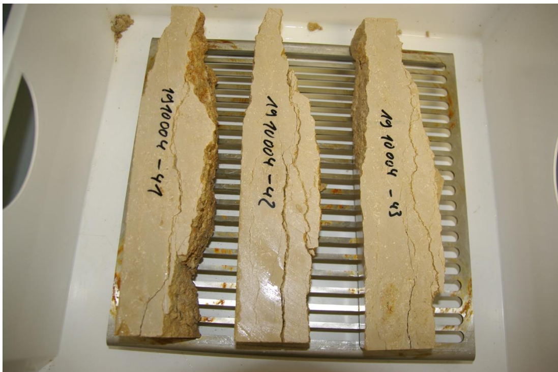
Foto 69: Prüfkörper -41 bis -43 nach dem 50. Zyklus
