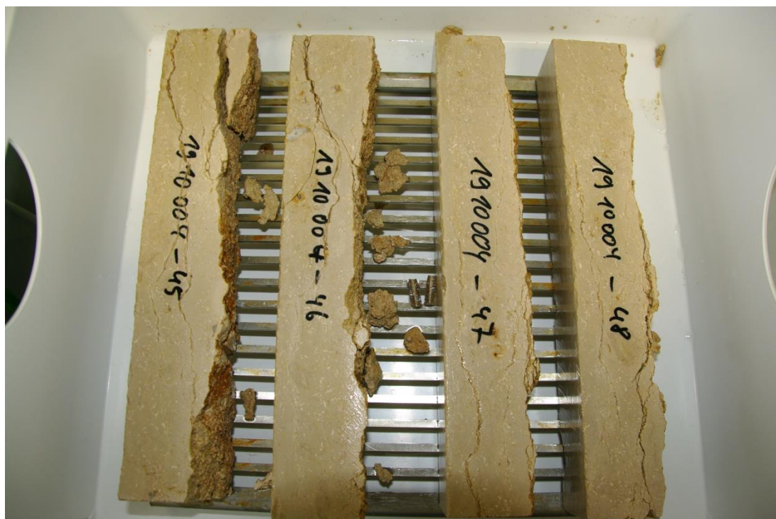
Foto 62: Prüfkörper -45 bis -48 nach dem 35. Zyklus
