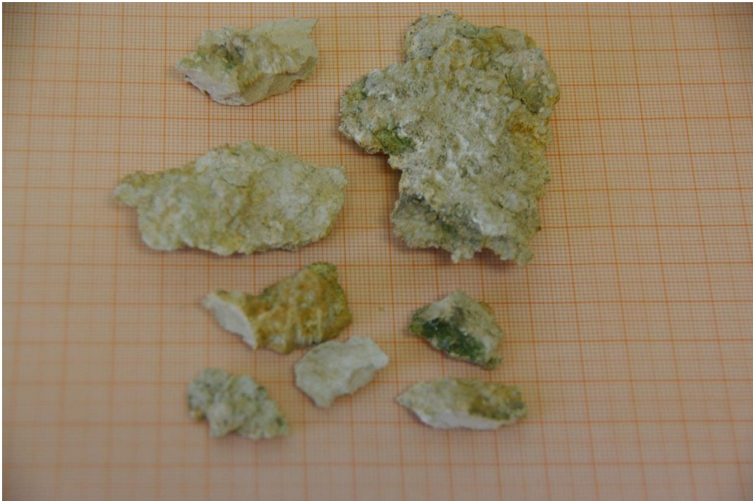
Foto 13: Beispiele für abgenommene Scherben; größtes Teilstück oben rechts: 7 cm lang, 5 cm breit, ca. 2 cm dick
