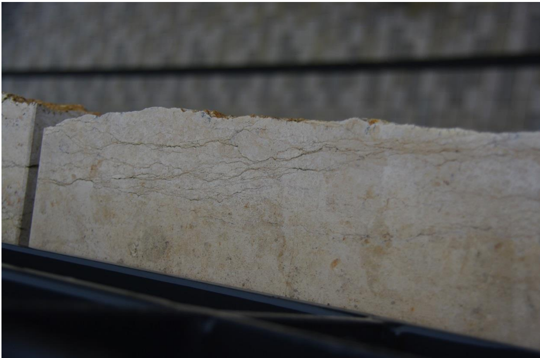
Foto 5: erkennbare Stylolithen auf der Steinoberfläche
