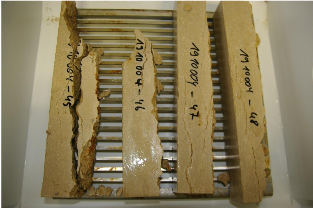
Foto 70: Prüfkörper -45 bis -48 nach dem 50. Zyklus; Prüfkörper -45 und -46 komplett zerstört
