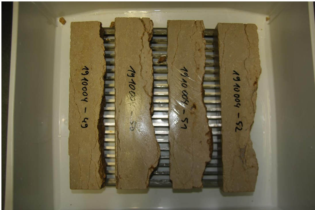
Foto 58: Prüfkörper -50 nach dem 20. Zyklus
