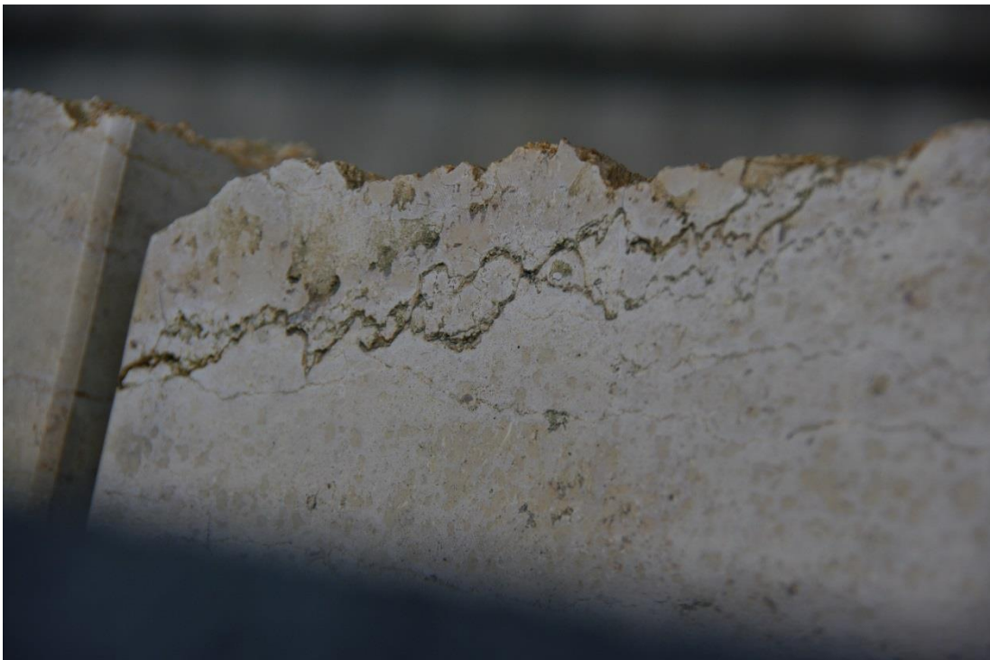
Foto 31: Beispiel für weiter hinten liegende Stylolithen, bei denen sich ggf. dickere Schichtpakete ablösen können
