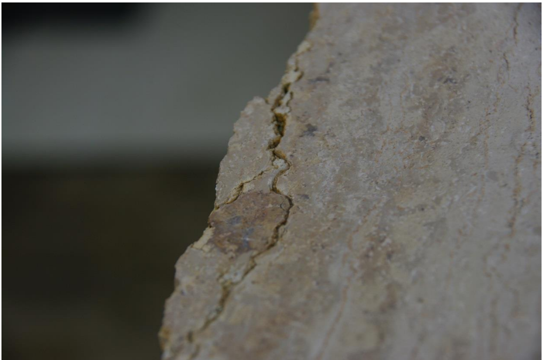
Foto 22: an der Krustenoberfläche „auskeilende“ Stylolithen; Scherbenbildung vorprogrammiert
