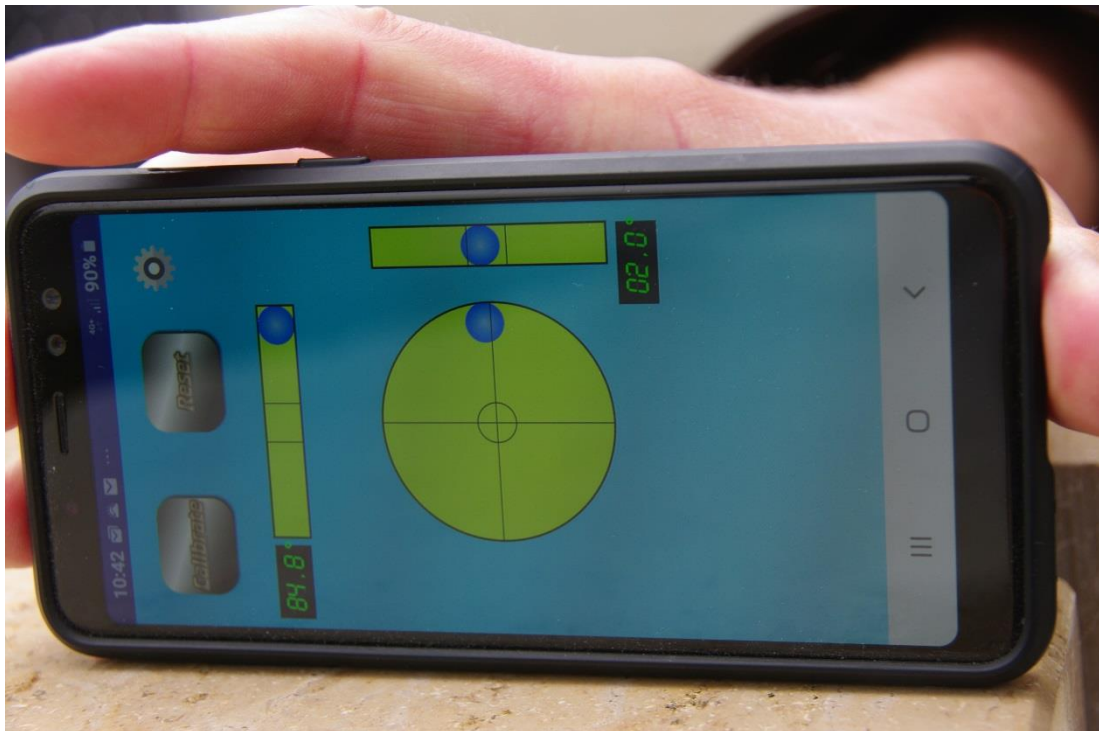
Foto 43: Neigung der Oberfläche der Steine nach hinten (innen) von 2°
