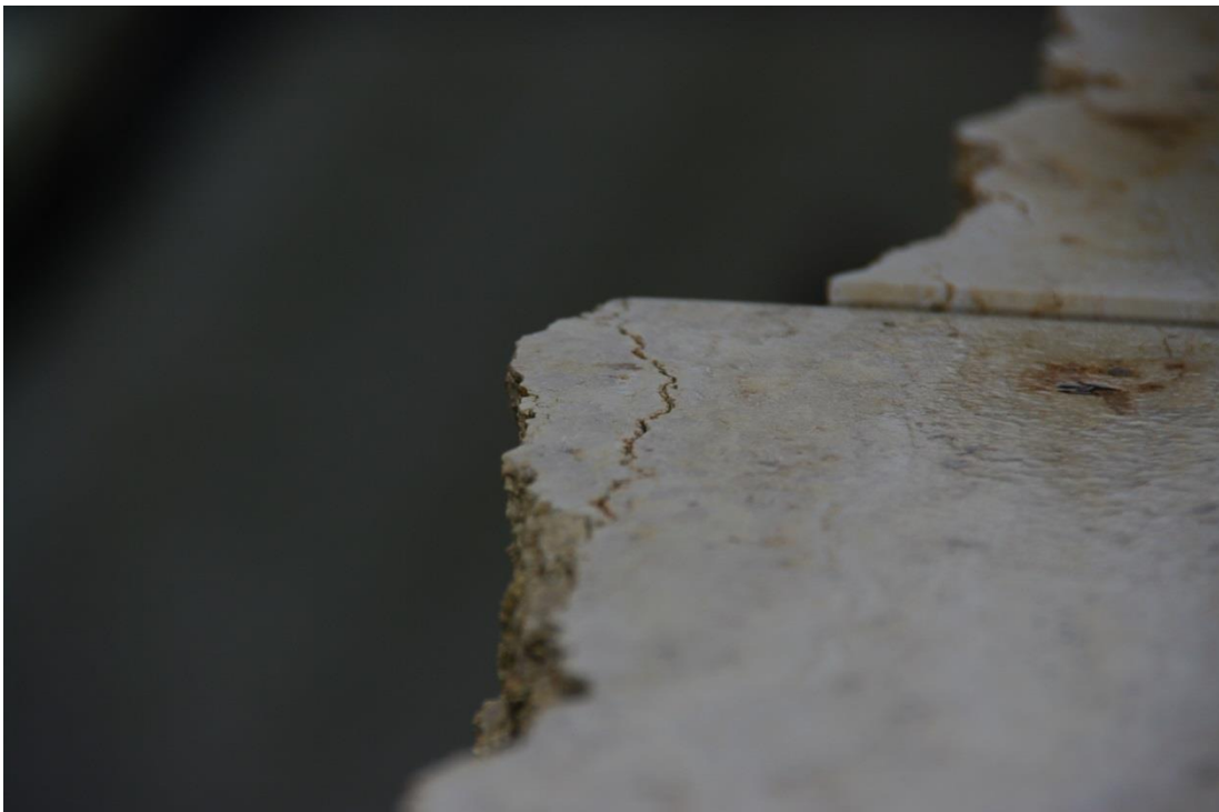
Foto 25: an der Krustenoberfläche „auskeilende“ Stylolithen; Scherbenbildung vorprogrammiert
