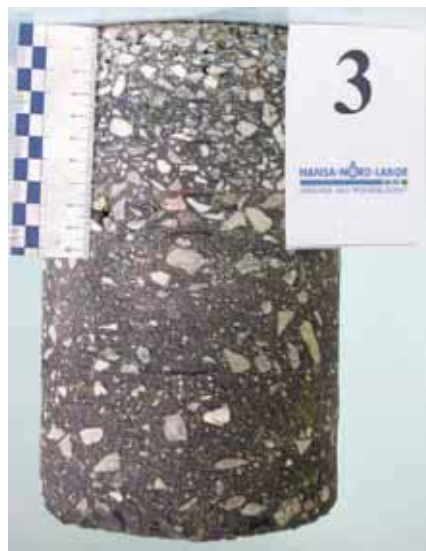
Entnahme von Bohrkernen zur Ermittlung des Schichtaufbaus (Hansa-Nord-Labor)
