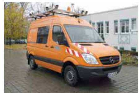
Datenerfassung durch Befahrung (Lehmann + Partner GmbH)
