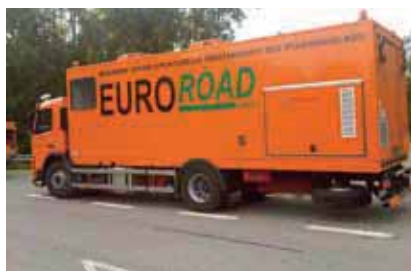
Tragfähigkeitsmesssystem Curviamentro (EuroRoad GmbH)
