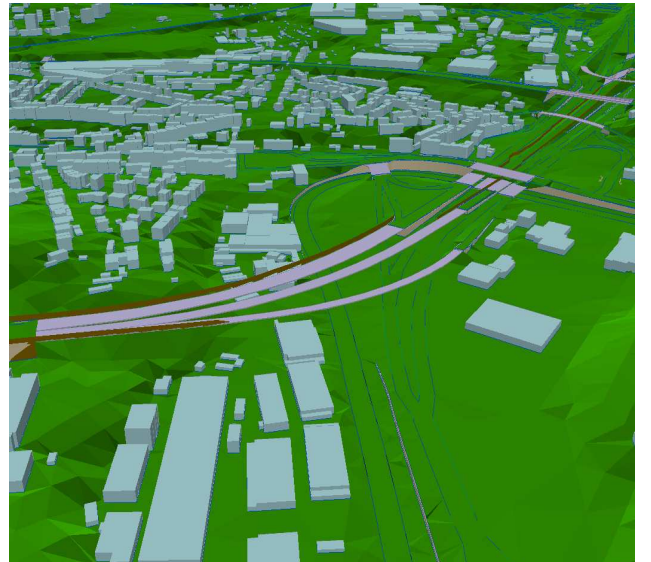
Ausgedünntes Geländemodell und künstliches Geländemodell einschließlich Straßen, Lärmschutz, Mauern und Bebauung
